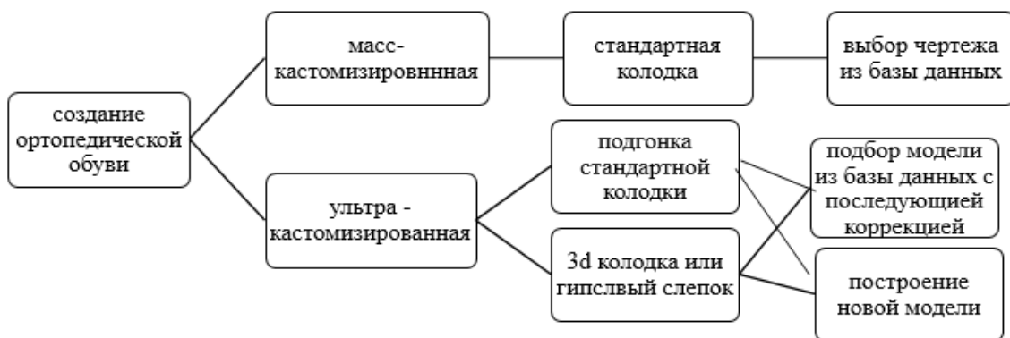
Рис. 1. Схема этапов создания колодок и чертежей масс-кастомизированной и ультра-кастомизированной обуви
