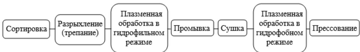
Рис. 3. Схема технологического процесса первичной обработки шерсти с применением плазменной обработки в гидрофильном и гидрофобном режиме
