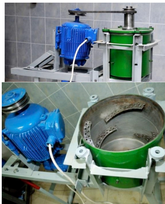
Рисунок 3 – Экспериментальная полупромышленная установка для исследования процесса смешения ССС.
