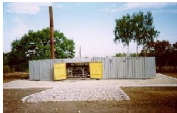
Рисунок 3 – Мобильный комплекс, размещенный в 40-футовом контейнере. В полевых условиях отработано обезвреживание 37 специальных рецептур (хлор-, фтор-, серу-, фосфорсодержащих) с рекордным уровнем экологической безопасности – 99,9999 % чистоты обработки. г. Шиханы Саратовской обл., 2002-2005 г.
