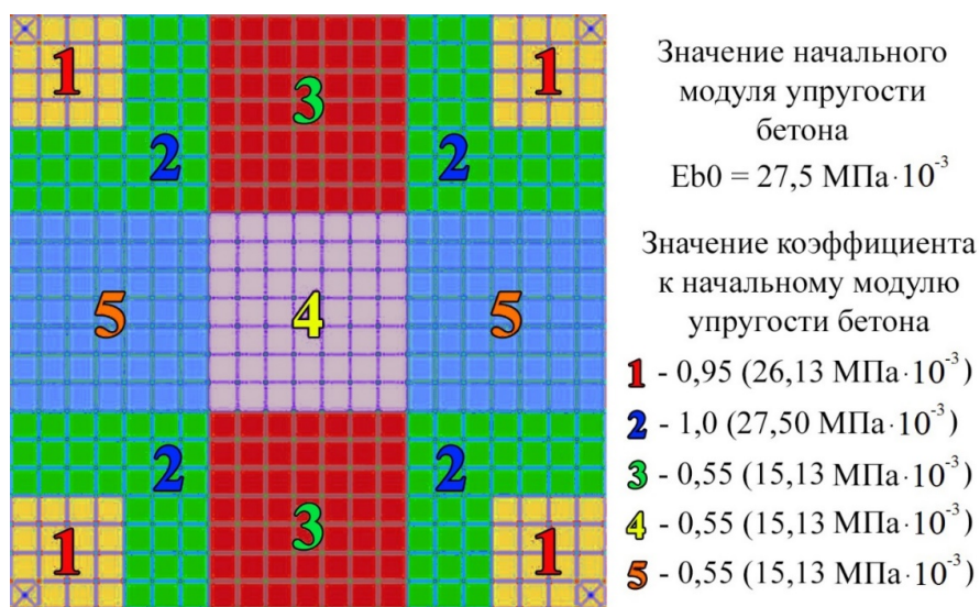
Рисунок 2 – Зоны уточнения модуля упругости бетона для 1 группы предельных состояний плиты размерами 6х6 метров из бетона класса В20
