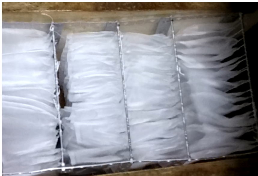
Рисунок 1 – Общий вид насадки типа PFF на опытном стенде.
