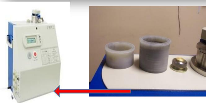
Установка радиометрическая УДИ-1Б, снабженная йодной кассетой на основе нетканого сорбционно-фильтрующего материала СФМ-2И
