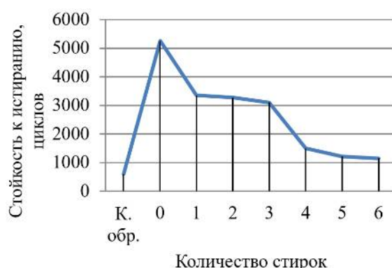
Рис. 1. Стойкость к истиранию, циклов: К. обр. - образец без покрытия; 0 – образец с покрытием без стирки; 1-6 образцы после стирок
