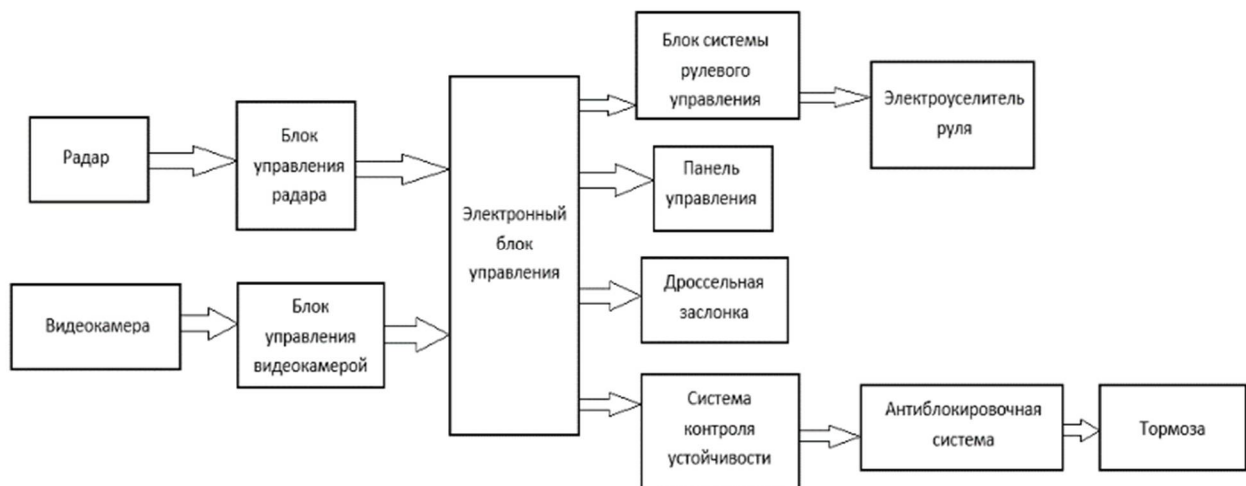
Рис. 1. Принципиальная схема системы адаптивного круиз контроля с исполняющими элементами
