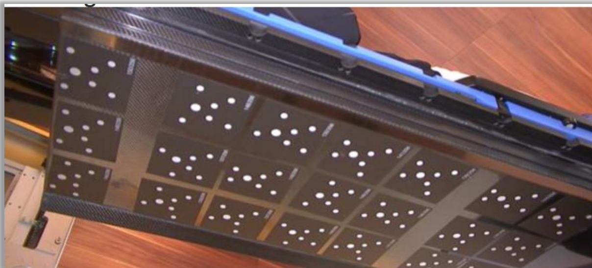
Рисунок 4.19 Маркеры отслеживания положения терапевтического стола
