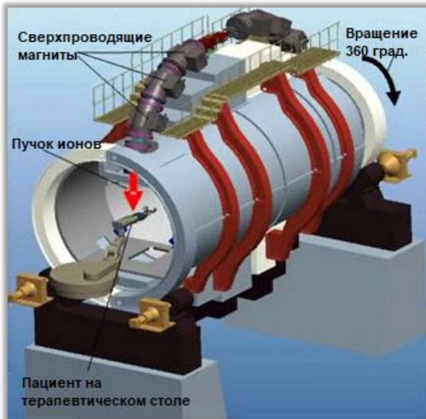
Рисунок 2.7 3-х координатная ротационная установка доставки пучка в ионно-протонном центре НИМАС (Чиба, Япония) [150]
