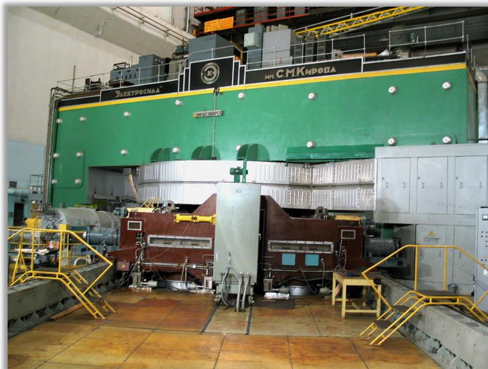
Рисунок 2.3 ММО ОИЯИ, Дубна, Фазотрон, используемый для генерации медицинского пучка протонов.
