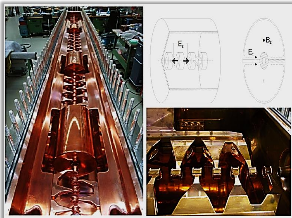
Рисунок 2.24 Встречно-штыревая H -моды структура ( E_z и E_t – соответственно продольная и поперечная составляющая электрического поля, B_z – продольная составляющая магнитного поля)
