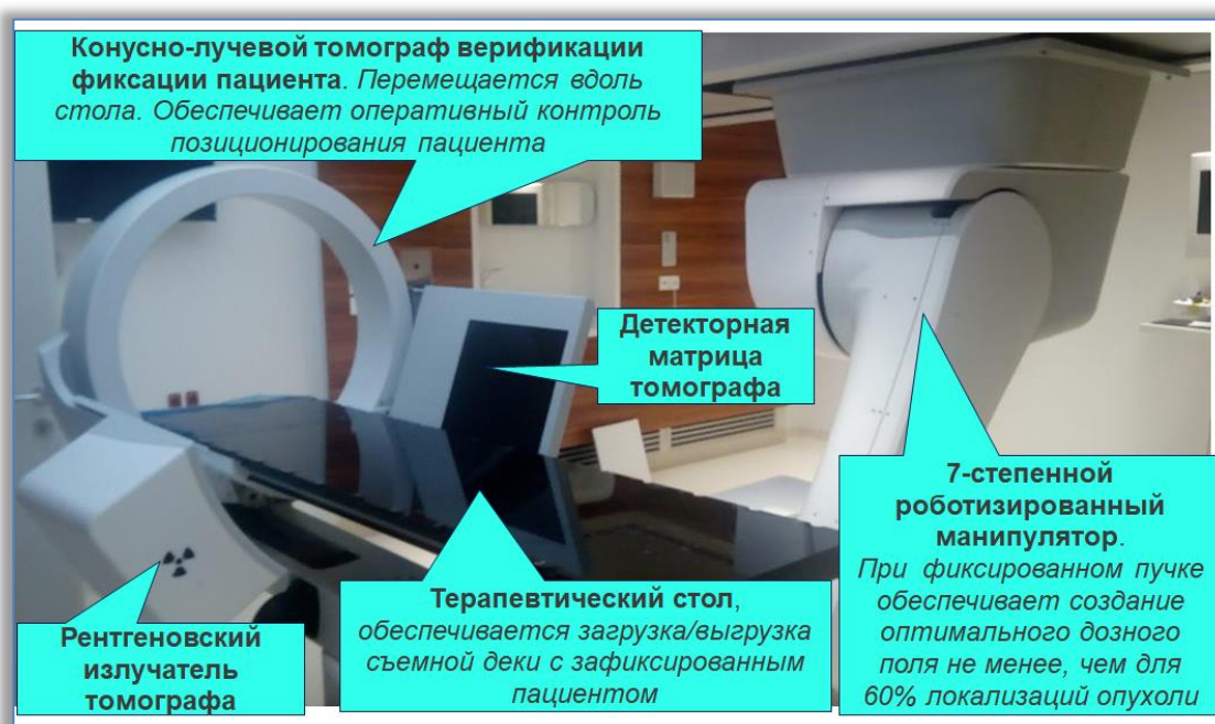
Рисунок 4.14 Модули: EXAMOVE 7C (7-степенной роботизированный манипулятор), EXATABEL (терапевтический стол) и EXAVIEW (подвижное кольцо с конусно-лучевым компьютерным томографом).
