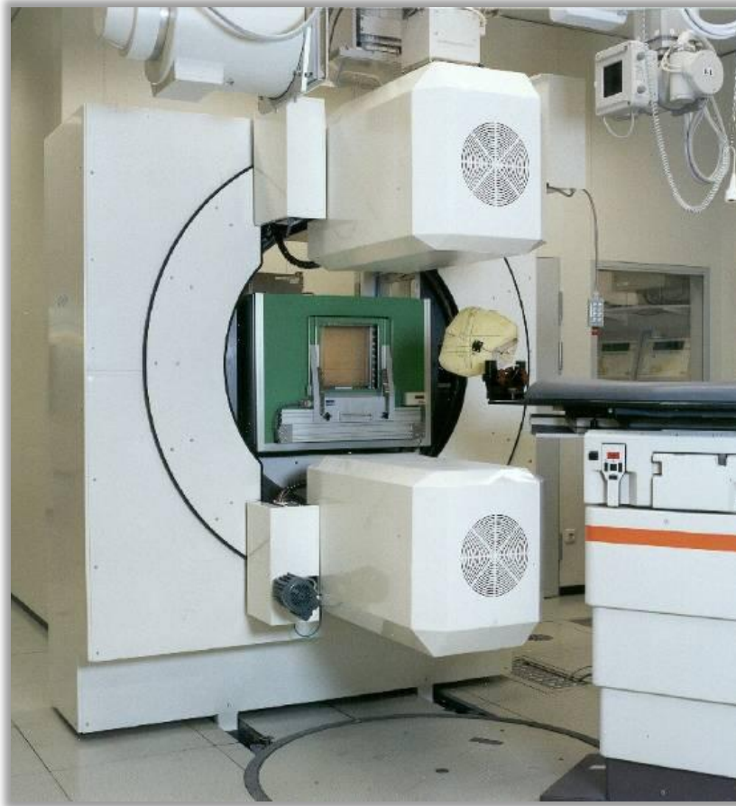
Рисунок 4.41 2-плоскостная ПЭТ-камера для измерения создаваемой дозы в реальном масштабе времени в центре ионно-протонной терапии CNAO (Павиа, Италия) [324]
