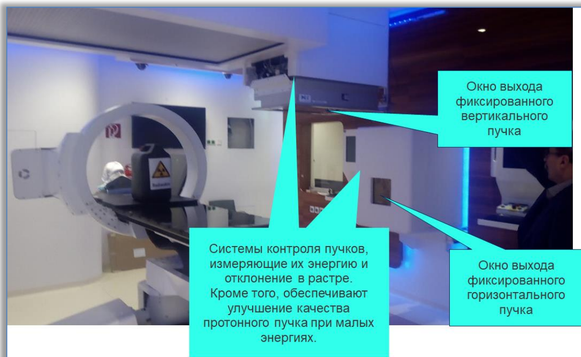
Рисунок 4.15 Модули EXAPOINT для вертикального и горизонтального пучков
