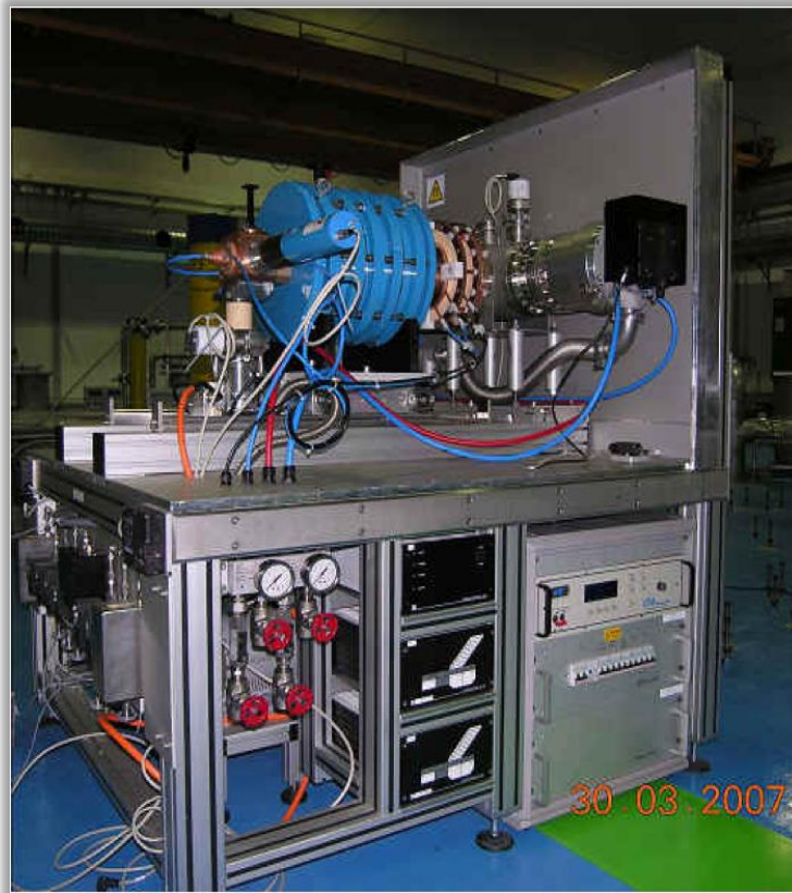
Рисунок 2.11 Источник ионов SUPERNANOGUN в ускорительном комплексе CNAO в центре ионной терапии в г. Павия (Италия).
