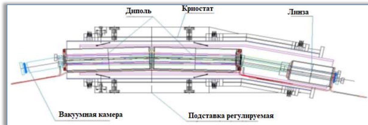
Рисунок 3.12 Модуль регулярной структуры из блока двух дипольных магнитов и квадрупольной линзы.
