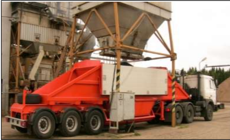
Загрузка автосамосвала с донной разгрузкой
