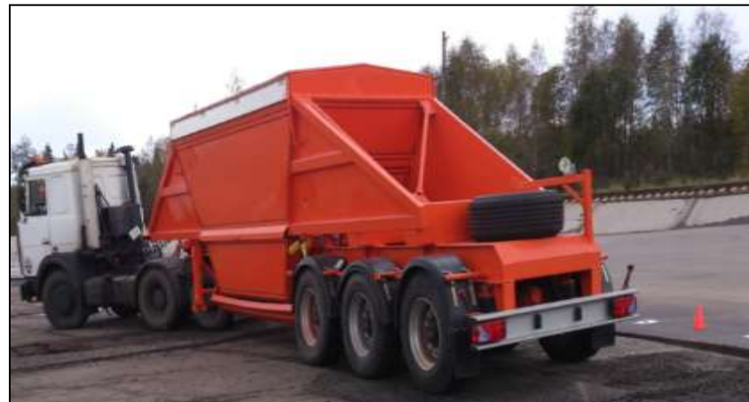
Автосамосвал с донной разгрузкой БЦМ-262
